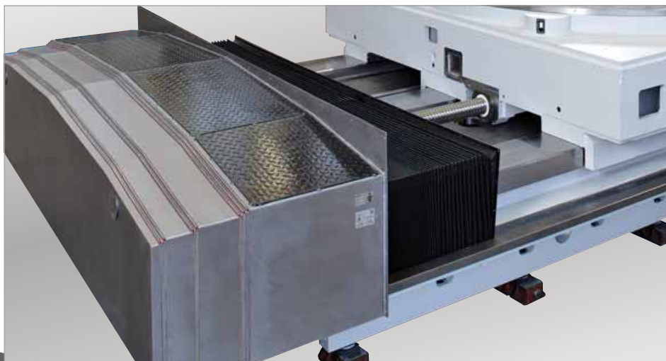
Hydrostatik wird mit zwei Abdeckungen zuverlässig vor Schmutz und Emulsion geschützt.
