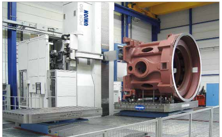
Fertigung von Getriebegehäusen, Werkstückgewicht 100t DRLTS 3000 / 4000x3500 / 130t
