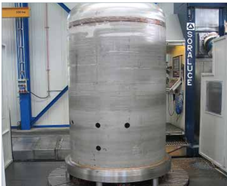
Drehen und Fräsen in einer Aufspannung Karussell-Drehtisch DRCT 2500 / Ø 2500 / 20t
