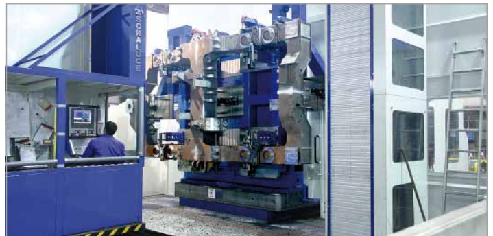
Modernste Drehgestellfertigung Vorrichtungsgewicht 20t, Werkstückgewicht je 10t, DRTS 2500 / 3000x2500 / 60t
